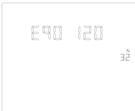
Рис. 1-57. Страница настроек времени задержки выравнивающей зарядки
